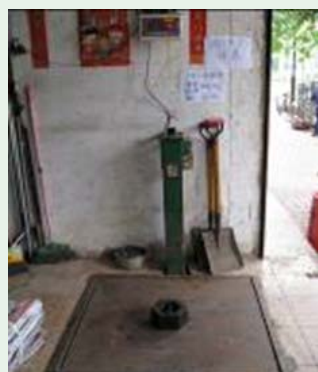
海關人員用一個 10 千克的標準砝碼檢查失靈的電子地磅時，所顯示的讀數為“9 千克”。
