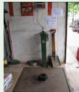
海關人員用一個 10 千克的標準砵碼檢查一個損壞的電子地磅時，所顯示的讀數為“9 千克”。
