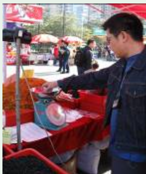
海關人員用經校正標準砝碼檢查針磅的準確度。
