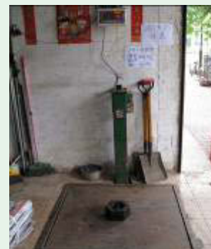
海關人員用一個 10 千克的標準砝碼檢查一個失靈的電子地磅時，所顯示的讀數為“9 千克”。
