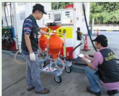
海關人員將預設容量的油泵到燃油測試容器內，以檢查柴油加油機的準確度。
