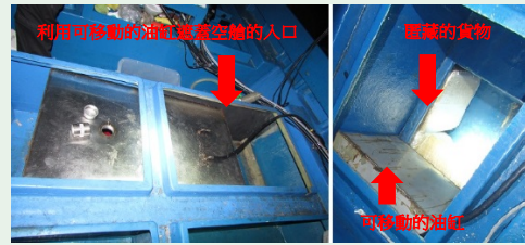
利用可移動的油缸遮蓋快艇上的暗格。
