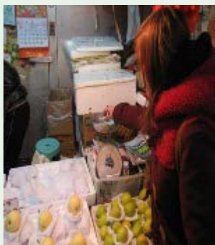
海關人員用經校正標準砵碼檢查針磅的準確度。
