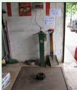
海關人員用一個 10 公斤的標準砵碼檢查失靈的電子地磅時，所顯示的讀數為「9 公斤」。
