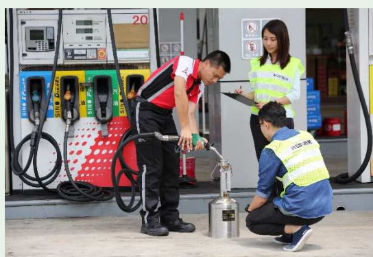
海關人員將預設容量的柴油泵到燃油測試容器內，以檢查柴油加油機的準確度。
