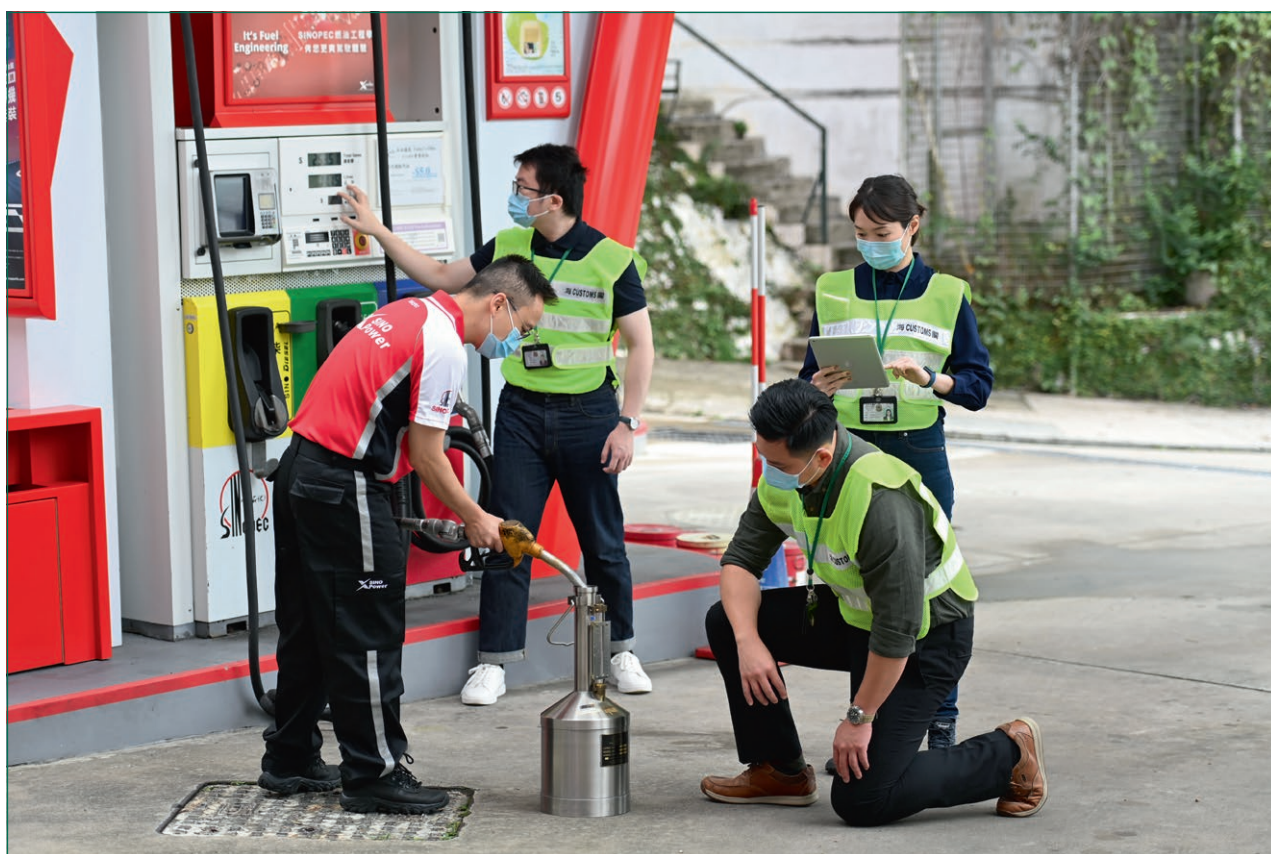
海關人員將預定容積的柴油泵入燃料測試容器以檢查柴油加油機的準確度。
