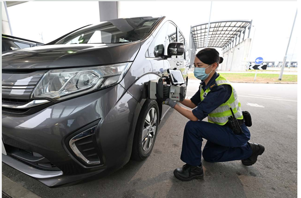
海關人員借助專業設備，例如手提X光檢查儀，檢測藏於運輸工具中的走私物品。
