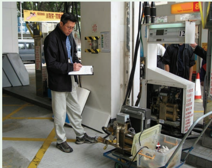
海關人員在加氣站中查核石油氣加氣機的準確程度。
