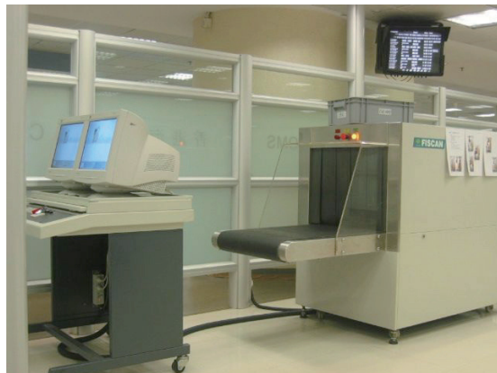
【圖五十七】 海關清關室內 X 光檢查機 [Picture 57] X-ray machine installed in Customs Clearance Cubicle
